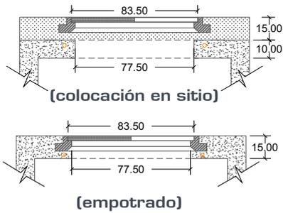
Nota: La altura total con aro y tapa empotrado se mantendrá en 210 cm; espesor de losa crece hacia abajo.
